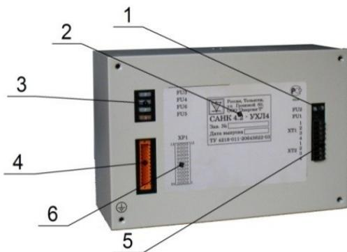
1 — предохранитель ГТПЧ (2 А), 2 — маркировочная табличка 3 — блок предохранителей, 4 — разъем ХР1, 5 — разъемы ХТ1 и ХТ2, 6 — цоколевка разъема ХР1.
