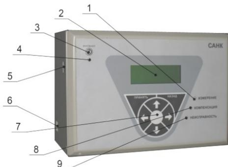
1 — индикатор «ИЗМЕРЕНИЕ», 2 — ЖК-экран, 3 — кнопка питания, 4 — индикатор питания, 5 — порт USB 2.0, 6 — порт Ethernet, 7 — клавиатура, 8 — индикатор «КОМПЕНСАЦИЯ», 9 — индикатор «НЕИСПРАВНОСТЬ».
