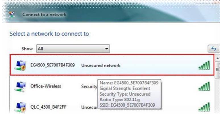
BLACKBOX Portable имеет встроенный IEEE 802.11g/b маршрутизатор со стандартной точкой доступа. Это обеспечивает наиболее удобную и простую связь прибора с любым ноутбуком или ПК с WiFi оборудованием.
