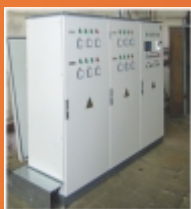
Шкаф управления моногонной печью на основе Контактторов тиристорных трехфазных регулятор ТЕРМОДАТ.
