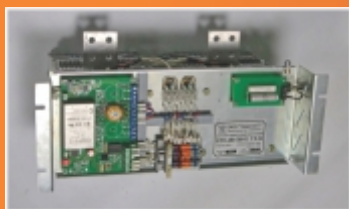
Однофазный контактор типа КТО для встраивания в 19' стойку. Степень защиты оболочки IP00.
