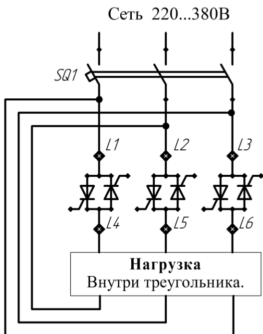
Пускатель тиристорный трехфазный КТТ-250-380-А3 УХЛ4.
