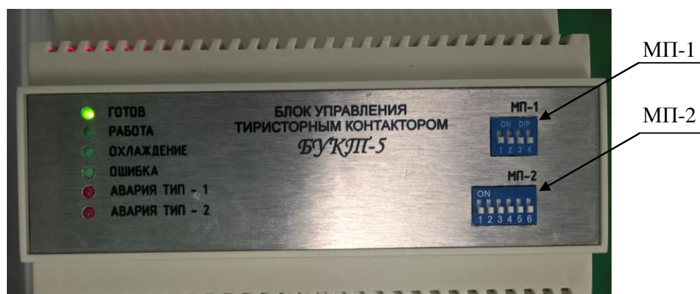
Рисунок 5 – Положение блоков переключателей на блоке управления
