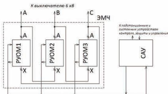
*РУОМ1...3 -- управляемые подмагничиванием реакторы;
